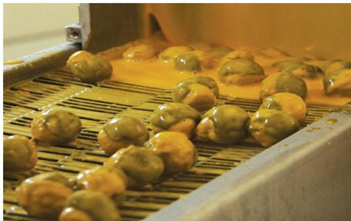
I **nastri a barrette intrecciate** in acciaio inox da noi forniti sono di elevata qualità, realizzati esclusivamente all'interno della comunità Europea in accordo con la normativa Europea **EC 1935/2004** relativa ai materiali destinati al contatto diretto con prodotti alimentari
