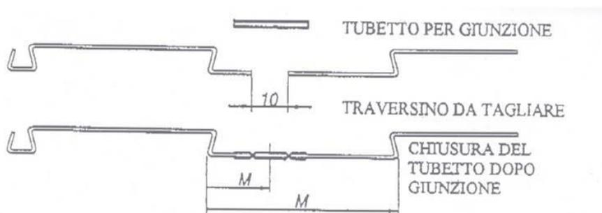
Una volta infilato il tubetto schiacciarlo alle due estremità con una pinza per bloccarlo
